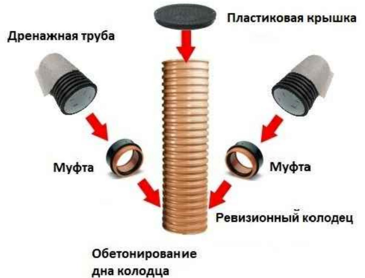
Примечание: система дренажа на территории частного домовладения подразделяется на 2 вида: дренаж участка; дренаж фундамента любых объектов капитального строительства. Представлены схемы установки дренажных пластиковых труб. Самые распространенные диаметры труб Ду110-160-200 мм. Прокладка дренажных труб обязательна на уровнях ниже глубины промерзания грунта и выше уровня грунтовых вод.
