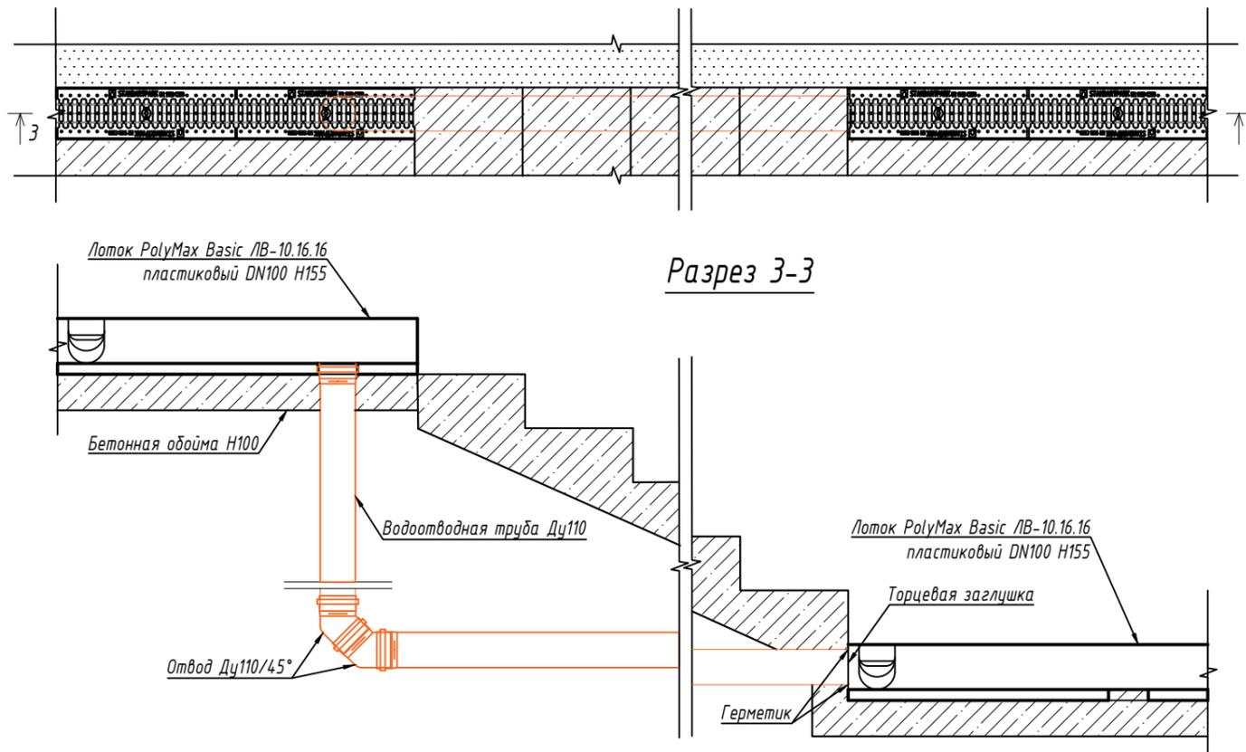
Примечание: территория частного домовладения очень часто имеет террасированный рельеф со множеством лестниц и переходов. Чтобы система поверхностного водоотвода была единой, необходимо связывать линии лотков трубными соединениями. На листе представлены два способа соединения линий лотков серии PolyMax через пескоуловитель и вертикальный выпуск из лотка. Для этого необходимо использовать трубные отводы. Аналогичным способом соединяются лотки серии CotroMax.
