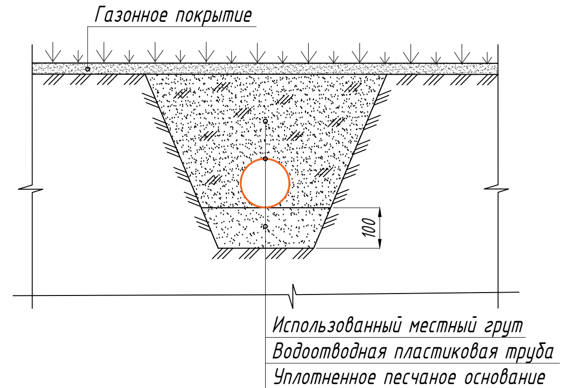
Схема установки водоотводной трубы
